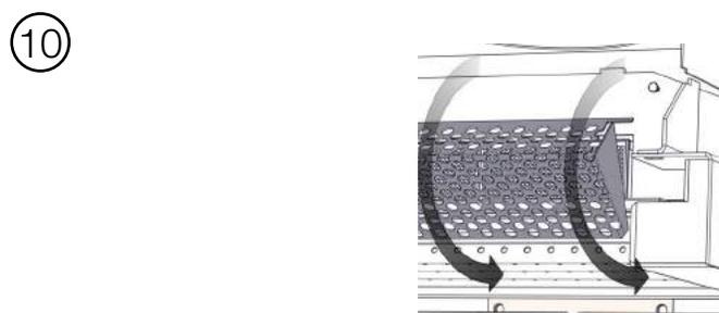
Réinstallez le panier perforé dans l'ordre inverse. Assurez-vous que le panier repose sur les boulons à épaulement de l'étape 2. Réinstallez le déflecteur en fibre.
