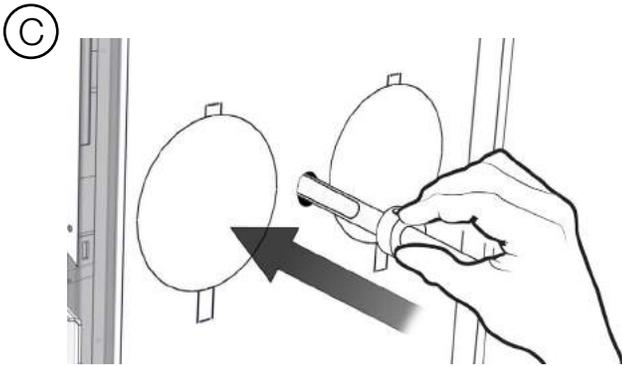
De l'extérieur de l'appareil, insérez l'embout de sonde dans le trou de l'élimination directe.
