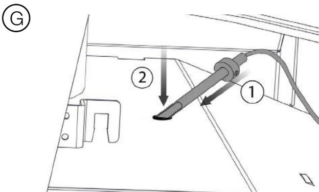
Insérez la sonde à un angle et progressivement redresser la sonde afin qu'elle est en panne.
