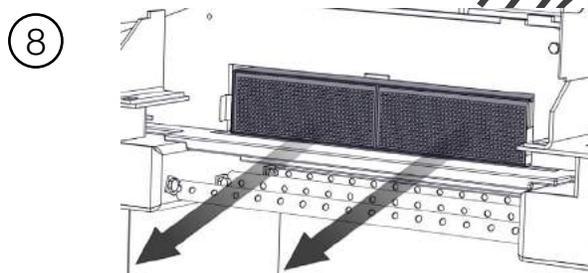
Sortez le catalyseur en le faisant glisser vers l'avant. Les languettes en acier sont retenues par friction et se séparent du filtre lorsque tiré.
