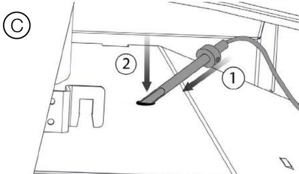
Insérez la sonde à un angle et progressivement redresser la sonde afin qu'elle est en panne.
