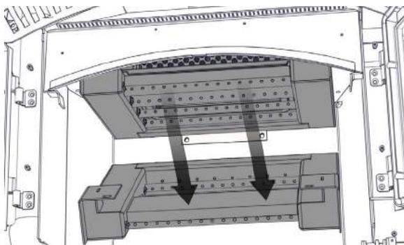
Retirez le collecteur d'air secondaire en le faisant glisser vers le bas et vers l'extérieur. Ôtez le joint arrière en grattant, puis nettoyez la surface. Fixez le nouveau joint à l'aide d'un silicone haute température (non fourni).
