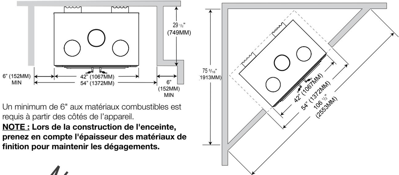
Un minimum de 6" aux matériaux combustibles est requis à partir des côtés de l'appareil.
