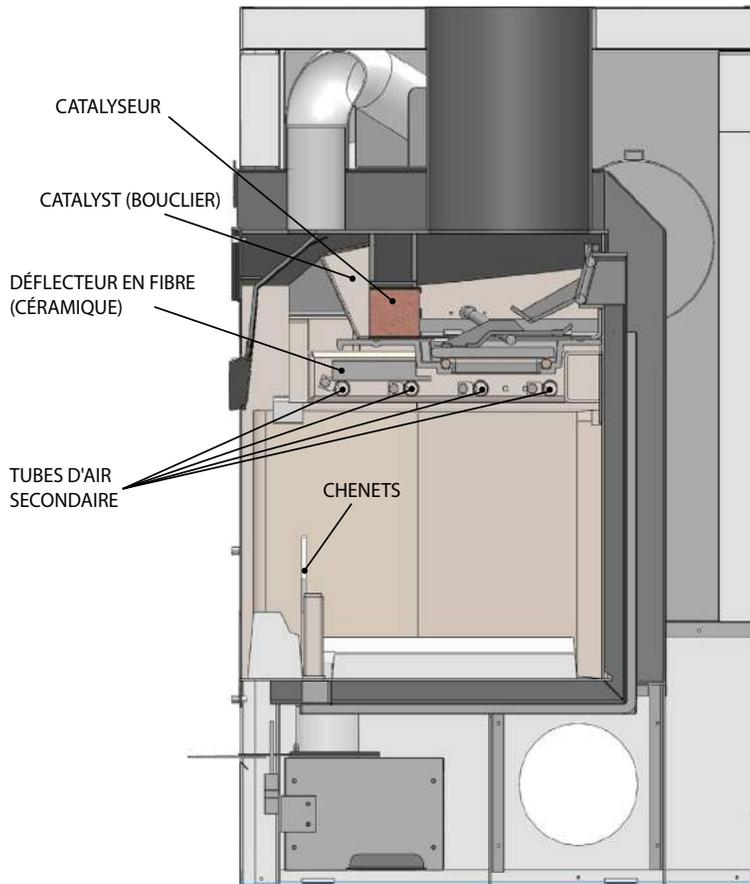
Le NZ3000H comporte un déflecteur en fibre de céramique, un catalyseur et un écran de catalyseur. Il est important d'installer correctement chacun de ces composants avant d'utiliser l'appareil.
