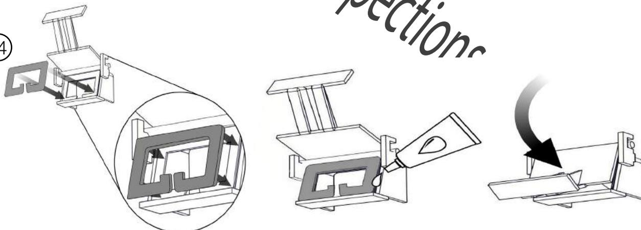
Appliquez un nouveau joint en le fixant à l'aide de ciment à poêle (non fourni). Ceci afin d'éviter l'effilochage des extrémités et de fixer le joint dans la position de l'encoche.
