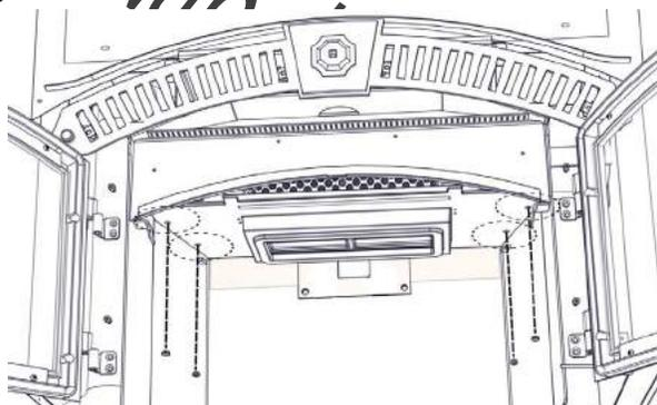
Retirez les écrous et boulons de chaque côté de l'appareil, tout en soutenant le déflecteur.
