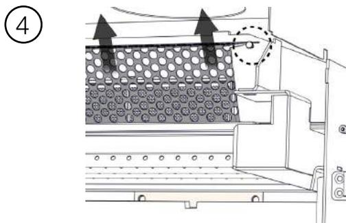
Faites glisser l'écran de catalyseur perforé vers le haut, au-dessus des boulons à épaulement.
