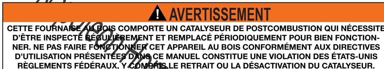
Une inspection périodique du catalyseur de postcombustion est nécessaire pour vous assurer du bon fonctionnement de l'appareil et pour déterminer le moment où le remplacement du catalyseur est requis. Le non-fonctionnement du catalyseur de postcombustion entraînera la formation de dépôts de créosote, une augmentation des émissions et une perte d'efficacité de la production de chaleur.
