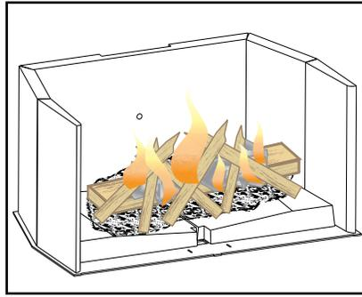
**E.** Lentement, ajoutez des morceaux de bois plus gros (2" x 4"). Posez les morceaux dans le lit de braises, parallèlement à l'arrière de l'appareil, tout en gardant une tranchée peu profonde entre les morceaux de bois. Ainsi l'air comburant primaire circulera directement dans la tranchée et allumera le bois.
