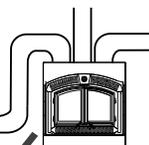
**\* S'il est installé avec une cheminée de maçonnerie, le système de chauffage central et l'option d'évent d'air chaud par gravité ne peuvent être installés que sur les côtés.**
