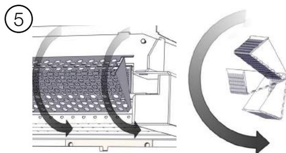
Faites pivoter l'écran de catalyseur perforé vers l'avant jusqu'à ce qu'il soit tourné vers le bas.
