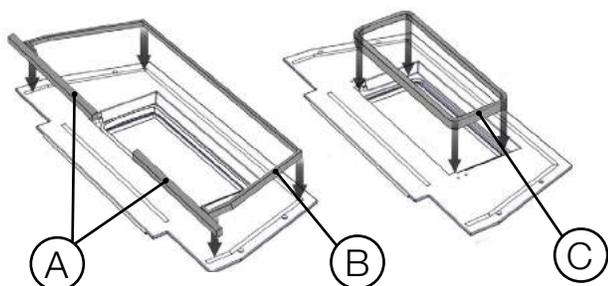
Remplacez les joints A, B et C. Fixez à l'aide de ruban-cache (non fourni).
