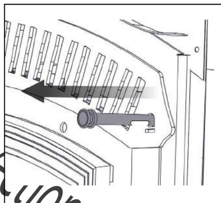
Tirez la tige de dérivation vers l'extérieur. Utiliser l'outil fourni lorsque appareil chaud.
