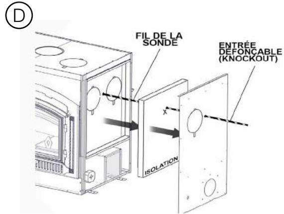
Il n'est pas nécessaire de retirer les panneaux de côté. L'image ci-dessus est présentée à des fins d'illustration.
